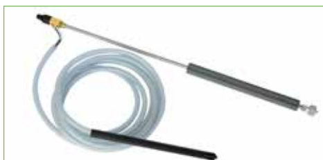
Gritstraallans van 900 mm met sproeier, snelkoppeling en aanzuigbuis, geschikt voor een werkdruk \leq 250 bar code: 1.258.220.xxxxx
